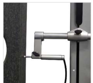
垂直度测量 (V6型号)
